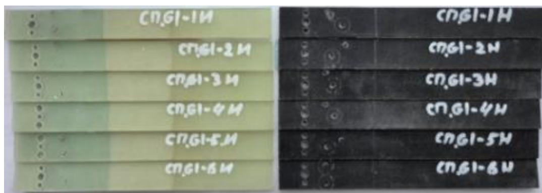
Рис. 1. Фотография образцов из стеклопластика двух серий «И» и «Н» для испытаний на вязкость разрушения при отрыве
